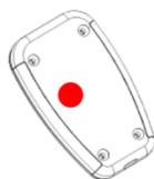
機器を強制的に再起動するには、ケースの背面にあるこの目的のための穴にペーパークリップを差し込みます。この操作でメモリや設定が消去されることはありません。機器を強制的に再起動させるだけです。
