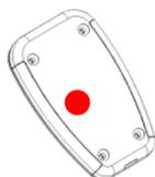
もし、バリオ本体が動かなくなった(ボタンに反応しなくなった、画面が固まった等)場合は、USBケーブルでパソコンに接続し、SYS PC ツールに繋げ、バリオ本体裏(左図箇所)の穴に針を刺してリセットボタンを押します。USBは接続したままで行います。
