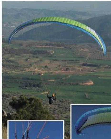
Bóveda elíptica con la parte central bastante plana, los anclajes del freno van muy separados y en el borde de salida, lleva mini-costillitas. Los estabilizadores son anchos y truncados, con cara torsión positiva. Abajo: 3 bandas, con la A dividida, bola en el puño y poleas cubiertas de neopreno, con cordón de Dyneema y un asa para tirar de las "Ces". Con 2 cordones en la A, las orejas tardan en quedar infladas con poco viento, subida ligera.
