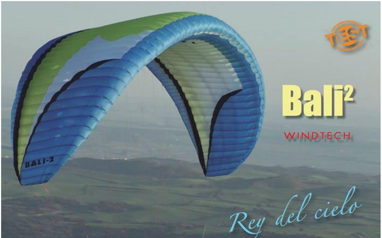
何と言ってもバリ 2 の素晴らしい点は、高速時の滑空性能である。その最大速度（50km/h）に至るまで極めて高い滑空比を保っている。
