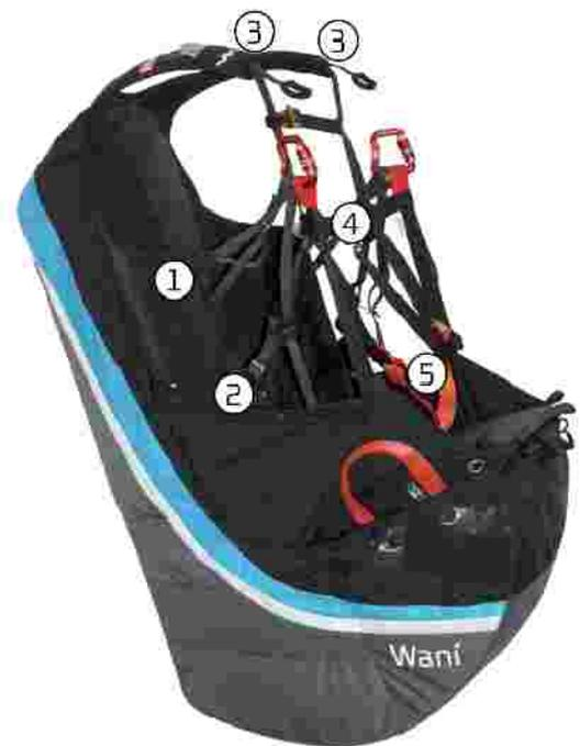
下記の写真で示したとおり、背中中の角度調整ベルトと座板の深さ調整ベルトはそれぞれさらに分かれてハーネスを支えています。垂直方向に対して上体をどれだけ後へ傾けさせるかの角度調整は、**1**で行います。では、脚と背中との間の角度（シートの深さ）を調整でき、腰椎と座板への荷重配分を変えて最適の居住性が得られます。
