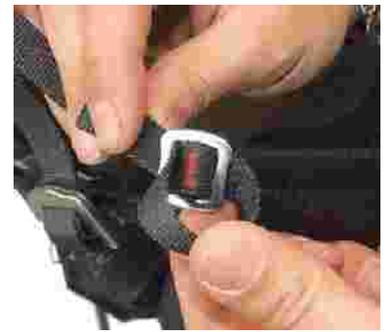
調整作業は、必ず緊急パラシュートを装填してから行なってください。そして、最適の調整を得るためには、適切なシミュレーターからぶら下がり、飛行時と同じ装備・収納品を再現して飛行時と同じ条件・ポジションでチェックしてください。
