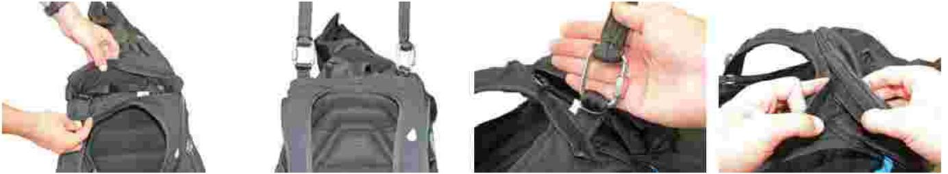
2箇所のブライダル接続にはそれぞれ1,400kg以上の破壊強度を持つねじロック型カラビナ(ラピッドリンク)を使用してください。また、緊急パラシュートのブライダルの長さが、開傘作業での緊急パラシュート引き出し時にも十分な長さを持ち、パラシュートをコンテナから引き出すさいにパラシュート本体が先にデプロイメントバッグから引き出されることがないか、をチェックすることが重要です。
