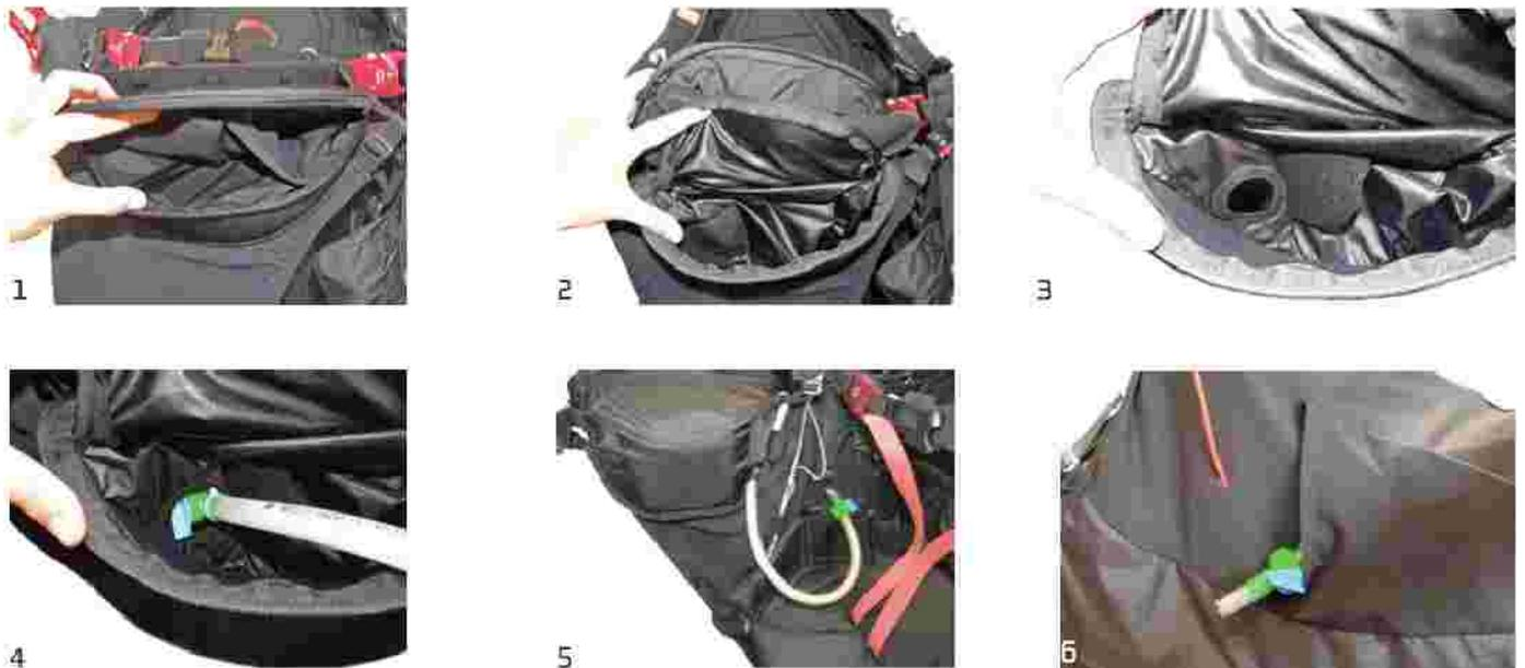
(1) 計器パネルの下のジッパーを開くと、(2)下がバラスト収納部になっています。(3)右下の排水チューブを通過させる穴をふさいでいるベルクロカバーを開きます。(4)排水チューブを通します。(5)ハーネスの内側から右の外付けサイドポケットの内側にもう1つ穴が開いているので、排水チューブを外付けサイドポケットの中まで通しておきます。(6)普段は排水コックを外付けサイドポケットの中へ隠しておいて、排水時に引き出して使用します。
