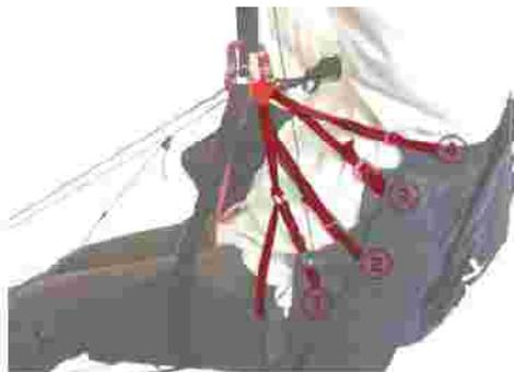
写真の中で、調整ポイント1番で脚（太もも）と背中との角度（シートの深さ）を調整でき、腰椎と座板への荷重配分を変えて居住性を追求できます。調整ポイント3番で、垂直方向に対して上体をどれだけ後へ傾けさせるかの基本的な角度調整を行います。その上でさらに調整ポイント2番と4番で背中の荷重配分を最適化します。
