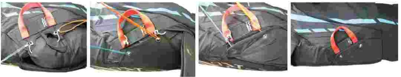
ハンドルについているメタルピンを、透明カバーの内側でハトメ穴から引き出したバンジーループの中へ差し込みます。メタルピンが差さったら、バンジーループ引き出しに使った細ヒモをはずしますが、このときバンジーを摩擦で傷めないように注意深くゆっくりと引き抜いていってください。最後にハンドル基部左右が伸縮性のカバーの下に来ていることを確認してください。
