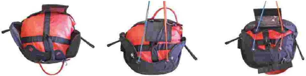
ハンドルについているメタルピンを、ハトメ穴から引き出したバンジーループの中へ差し込みます。ハンドル基部左右を布製カバーの下に差し込みます。最後に、メタルピンを差したらバンジーループ引き出しに使った細ヒモをはずしますが、このときバンジーループを摩擦で傷めないように注意深くゆっくりと引き抜いていってください。ピン確認の透明カバーが突いたフラップを赤いハンドル部の下を通して貼ります。緊急パラシュートをフロントコンテナに装填したら、2本あるブライダルのループをそれぞれ左右のカラビナへつなげなければならぬのですが、右側のループは右のカラビナへ最初からつなげたままとなり、左のループはテイクオフでハーネスを着るたびに左のカラビナへ取り付けます。
