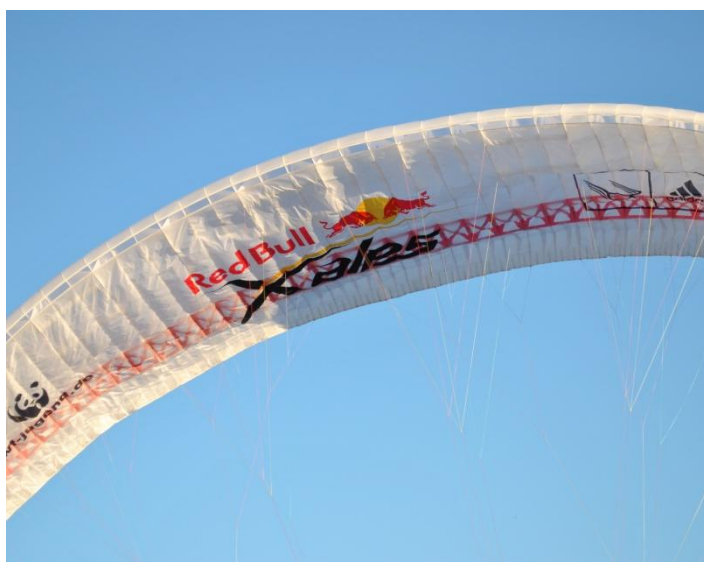
MAVERICK RX プロト flown by タケシ チタンバテン挿入のこのコンセプトモデルは、シリアル コンペ機等へのフィードバックが期待される。 チタンバテン仕様の MAVERICK2.2 TI の構想も。
