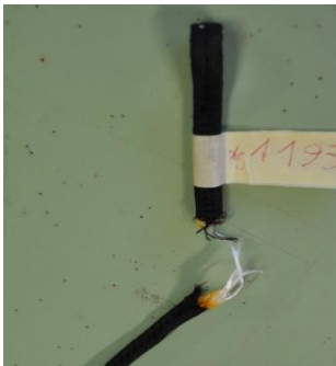
破断時の荷重が記された各サンプル、あらゆるパーツやウエビングがテストされてから採用される
