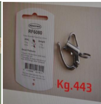
破断時の荷重が記された各サンプル、あらゆるパーツやウエビングがテストされてから採用される
