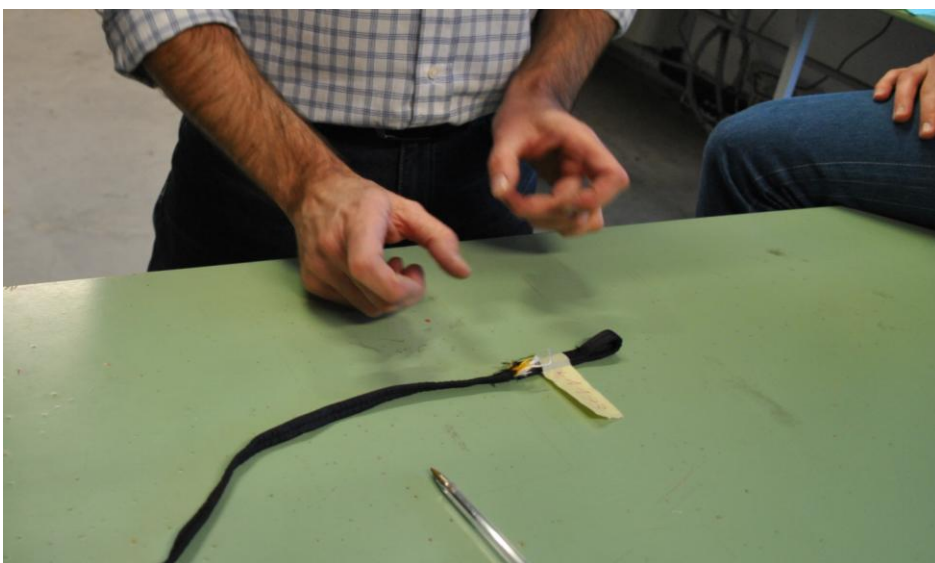
破断時の荷重 1123Kg と記された素材、折り返しの縫代の長さによって素材の破断強度は変わる
