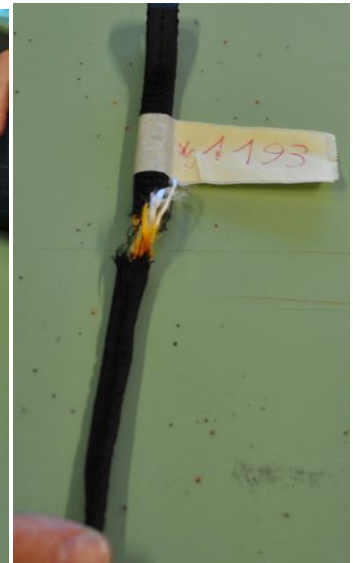
破断時の荷重 1123Kg と記された素材、折り返しの縫代の長さによって素材の破断強度は変わる
