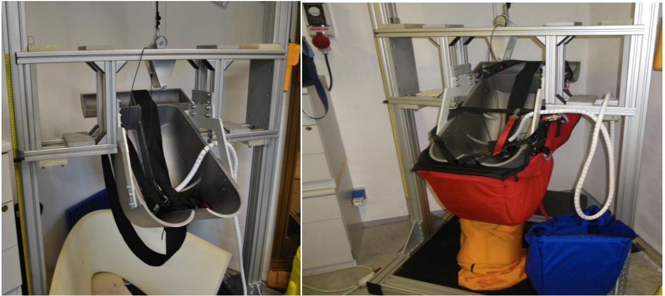
ショック荷重を測定するテストマシーン、右は先年採用されなかったエアフォーム・プロテクション
