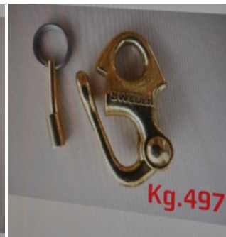
破断時の荷重が記された各サンプル、あらゆるパーツやウエビングがテストされてから採用される
