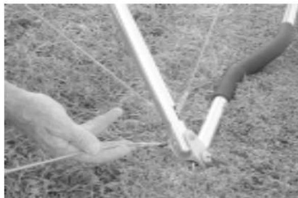
\*コントロールバートップもネオプレーンカバーをずらしてボルト・ナット・クレビスピン・セーフティリング・ブラケットをチェックします。
