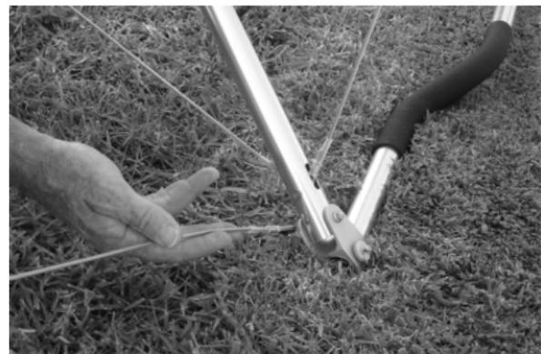
7) キールポケットからキールに沿って後ろへ出ている細いひも（太さ 1mm強のパラグライダーのライン）を引っ張り、その先のクロスバーテンションワイヤーのキーホールタングがキールポケットから完全に出てきたらそれを後ろへ引っ張って、キールのカラードボルトの付け根に組み込みます。クロスバーテンションワイヤーがキールを巻いていないか確認してから引っ張ってください。続いてリアワイヤータングも同じカラードボルトに上からしっかり押し込んで組み込みます。
