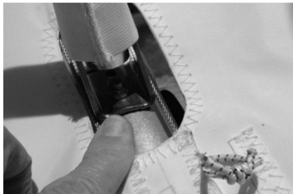
\*どちらか片翼の前縁に手をかけてサイドワイヤーの中央部付近を30kg強の力で踏むと、飛行中にかかるのと同じ荷重チェックをすることができます。サイドワイヤー・コントロールバー・クロスバーの構造系で、通常の飛行で破壊に至るような損傷はこの時点で発見できることが期待されます。
