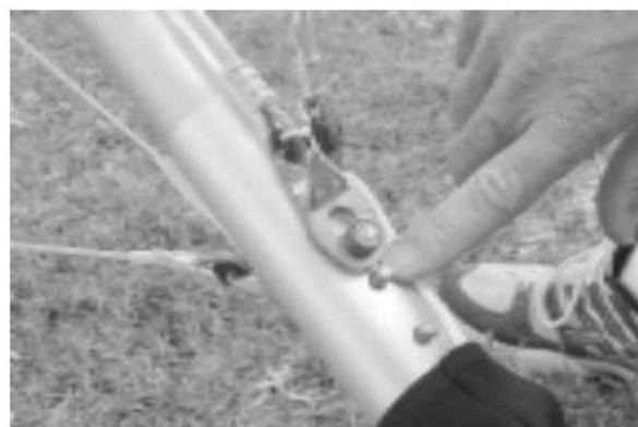
\*キングポストベースブラケットをキールに止めている1/4インチサイズのクリンチナットがゆるんできていないか、チェックして下さい。組み立て前の状態で長大なキングポストを左右に振ってしまうと、ナットだけではトルクが抑えられずに緩んでくることがあるので、注意して下さい。(締め直しの使用工具は8mmレンチと大き目のプラスドライバーです。)また、クロスバーテンションワイヤーがキングポストベースブラケットのあたりで傷んでいないかチェックして下さい。
