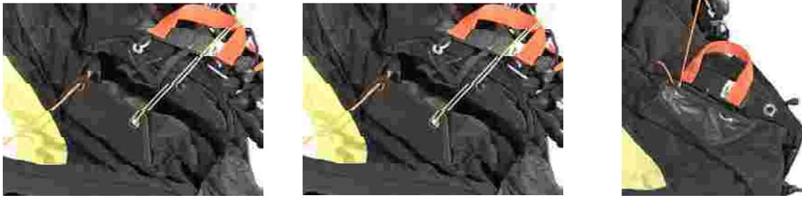
ハンドルについているメタルピンを、透明カバーの下のハトメ穴から引き出したバンジーループの中へ差し込みます。メタルピンが差さったら、バンジーループ引き出しに使った細ヒモをはずしますが、このときバンジーを摩擦で傷めないように注意深くゆっくりと引き抜いていってください。（ヒモをメタルピンの下側に回してから抜くと良いでしょう。）最後に、伸縮カバーがハンドルの上になっているようにしてください。
