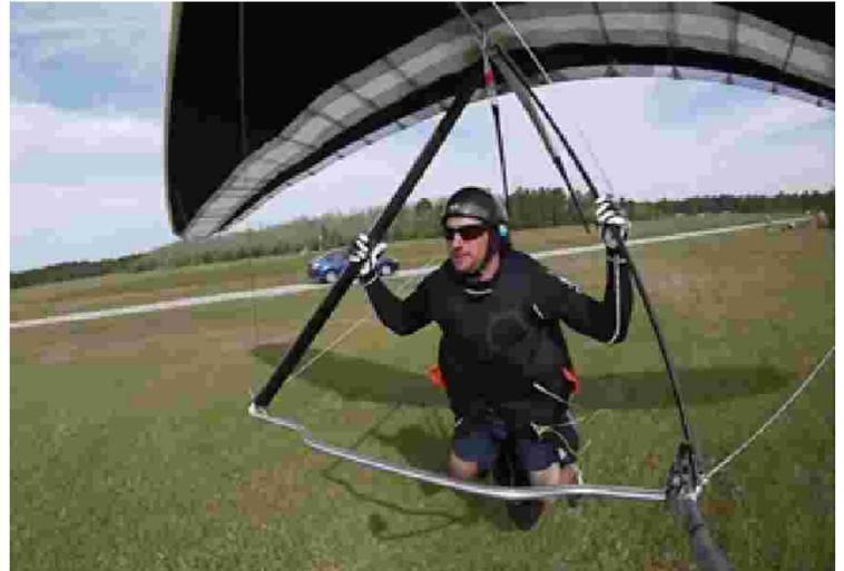
コバートは、カーボンバックプレートに 1 本吊りメインラインと尻押しスイッチのピッチラインで構成されるハイエンドのレースハネスです。しかも純度の高いアルミブロックからCNC削出し加工したうえ硬化処理まで施された、特別設計のバックプレートインサートによって、スライダーメカニズムの抵抗がなく、ハネスの姿勢制御がとてもスムーズで楽になりました。アップライトポジションもしっかり決まります。
