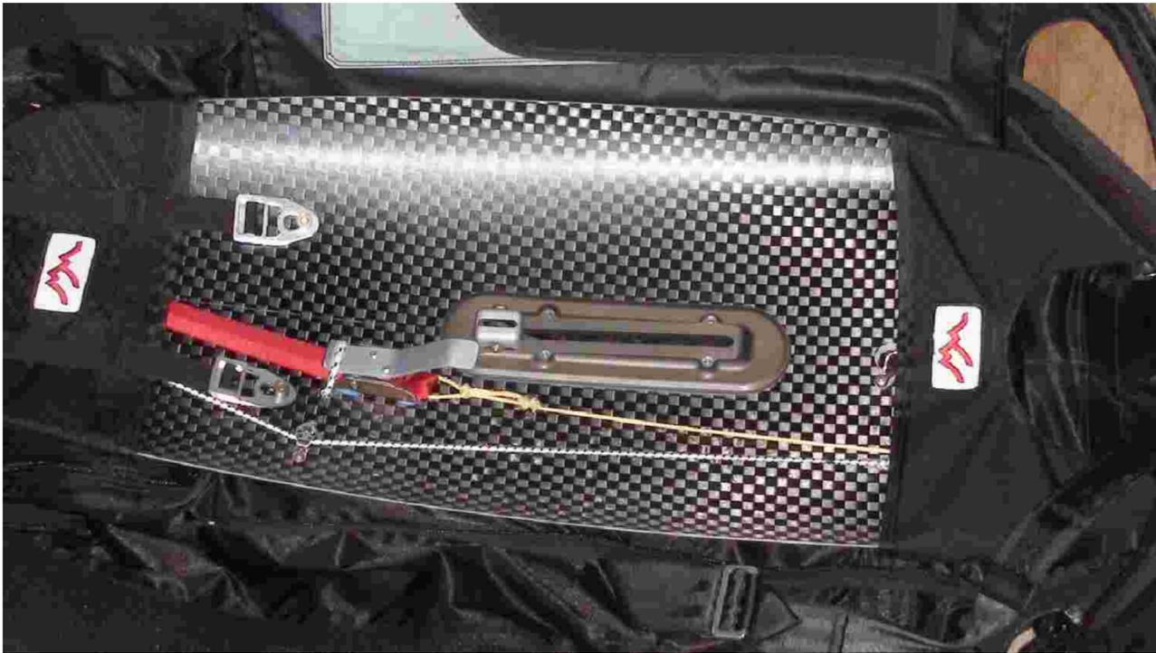
ピッチラインロックを操作する尻レバーは従来のシステムを踏襲しながらも、集大成された絶妙のセッティング、高級で高精度の部品、そして精密なバックプレート形状によって、操作が軽く、確実な作動を実現。尻レバーピッチライン方式の決定版と言えるでしょう。
