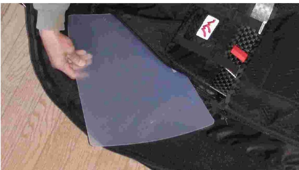
カーボンプレート後端部でハーネス背部に段が生じないように、取り外し式の厚手の塩ビシートで延長成形。
