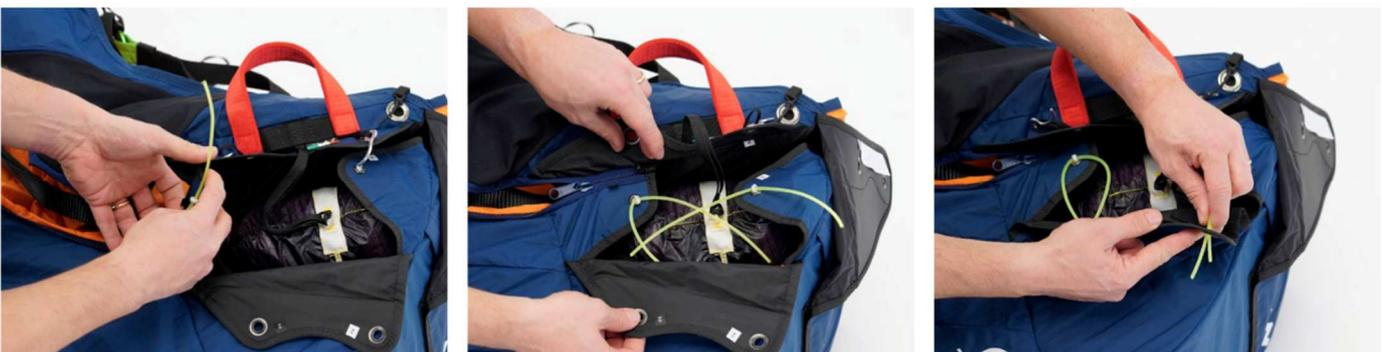
ハンドルについているメタルピンを、透明カバーの下のハトメ穴から引き出したバンジーループの中へ差し込みます。メタルピンが差さったら、バンジーループ引き出しに使った細ヒモをはずしますが、このときバンジーを摩擦で傷めないように注意深くゆっくりと引き抜いていってください。（ヒモをメタルピンの下側に回してから抜くと良いでしょう。）最後に、ジッパーを完全に閉じ、ジッパースライダーが左の肩ベルトの後ろのカバーの下に入っているようにしてください。
