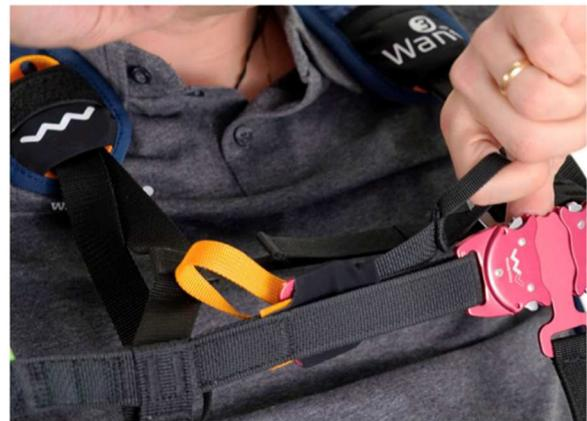
さらにもう1本のベルトもあり、肩ベルトの間隔を調整することができます。そしてこのベルトがあると万が一胸ベルトをつけ忘れた時にパイロットがハーネスから抜け落ちるのを防いでくれます。
