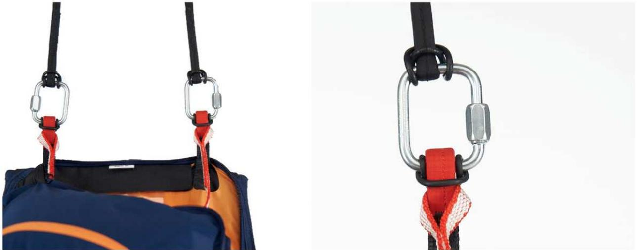
2箇所のブライダル接続にはそれぞれ1,400kg以上の破壊強度を持つねじロック型カラビナ（ラピッドリンク）を使用してください。また、緊急パラシュートのブライダルの長さが、開傘作業での緊急パラシュート引き出し時にも十分な長さを持ち、パラシュートをコンテナから引き出さずにパラシュート本体が先にデプロイメントバッグから引き出されることがないか、をチェックすることが重要です。
