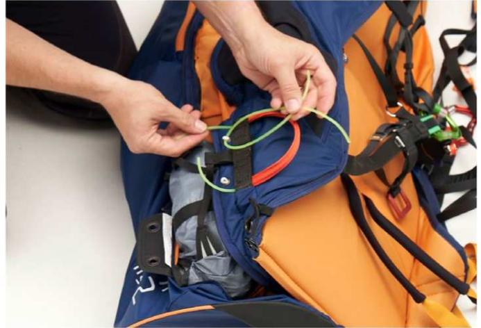
ブライダルカバーのジッパースライダーともう1つのコンテナの前側に来るジッパースライダーをハンドルの真下の起点へ持ってきます。ジッパーをそこから左右へ約20cm締めて下さい。以下の写真のとおりコンテナのフラップを閉じます。この作業の際にジッパーが開いてこないよう注意してください。2本の黄色プラスチックピンをバンジーループに通したらフラップのカバーの中へ入れておきます。
