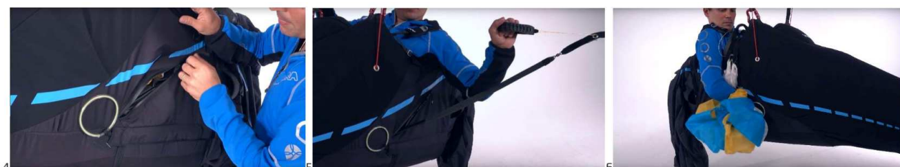
(1) 「アンチG」サイドポケット、(2) ドラッグシュートのブライダルを接続するラピッドリンク、(3) (4) アンチGの収納、(5) ドラッグシュートの引き出し例、(6) アンチGの収納
