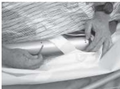
LE/Rをまっすぐ後ろに引き抜き、LE/Fからはずします。このときLE/R前端に2つのクレッセントリデューサーが付いてきている事を確認し、それぞれクレビスピンと六角ネジを取り付けなおしてください。次にLE/Rについているアウトースプログを翼端方向へ折りたたみなおし、LE/Rを前にずらして、慎重にインナーアクセスジッパーからLE/Rをセールの外に出していきます。LE/Rをセールから取り出したら、LE/R前端、スプログ先端や基部の金具類とセール内のLE/F後端に適当なパッドかカバーを取り付けて、輸送中にセールが傷まないように処理してください。
