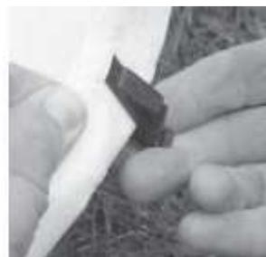
レバーはヒンジ部で外すことが出来るので、レバーのフックが割れたときは簡単にパーツ交換できます。また、ブレークダウン作業になれていない時はレバー部がうっかり外れて紛失しないよう注意して下さい。レバー部を受けるネジ込み部もバテン本体から外して簡単に交換することが出来ますが、バテンテンションが変わらないよう、同じネジ山調整となるように注意して下さい。
