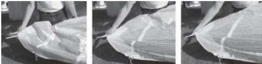
\*もうひとつの方法として、クロスバーを張る前に翼をゆるく開いた状態で、先にキャップをはめる作業を行うと、軽い力で作業できます。（ただし今度は、クロスバーを張る作業が重くなります。）この場合、翼端の後ろ外側から、片手でセール内のチップロッドをつかみ、もう片方の手でチップレバーをしっかり握って、ほぼ直線的に、セールチップレバーをチップロッドに沿って引っ張ります。チップレバーのキャップがチップロッドの先端に斜めにかかったら、そのままキャップにチップロッド先端がすっぽりとはまるようにキャップを起こします。
