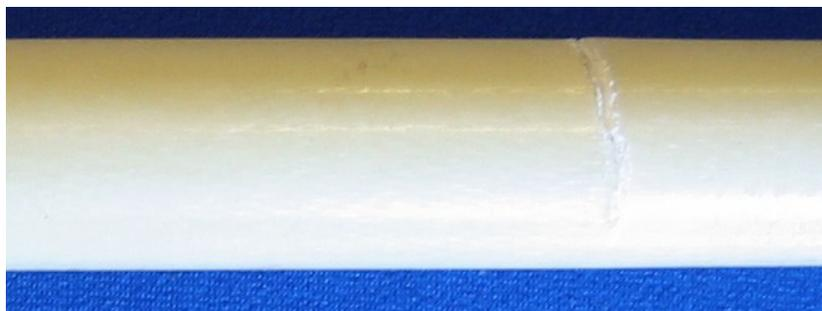
※破損したチップロッド（1mm以上深さの溝損傷）
